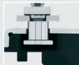
Achtkant-Sicherheitsverschlussbolzen im Sicherheitsschließblech fest verankert
